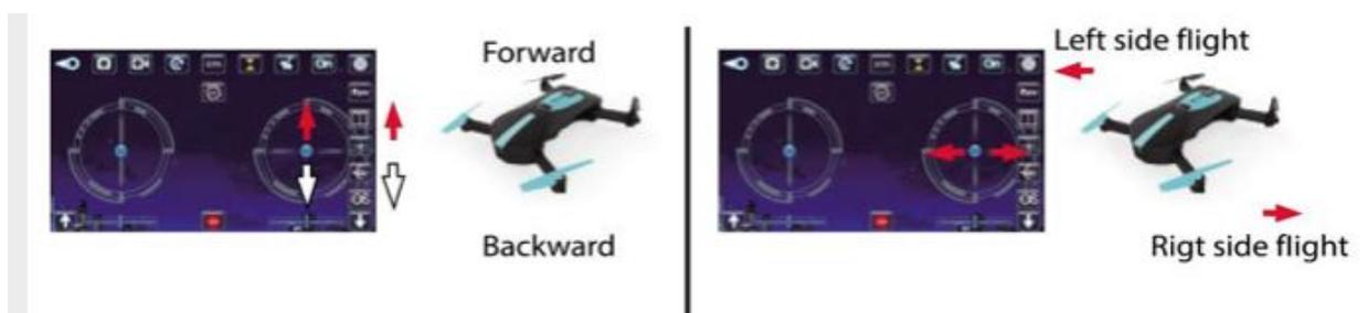
empujar hacia arriba la derecha palanca de mando (timón), el Quadcopter volará hacia adelante Empuje hacia abajo la palanca de mando derecha (timón), el Quadcopter Wil volar hacia atrás.
