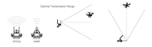
Asegúrese de que la aeronave está volando dentro del intervalo de transmisión óptimo. Ajuste la distancia y la posición entre el operador y la aeronave para conseguir un rendimiento óptimo de la transmisión.
